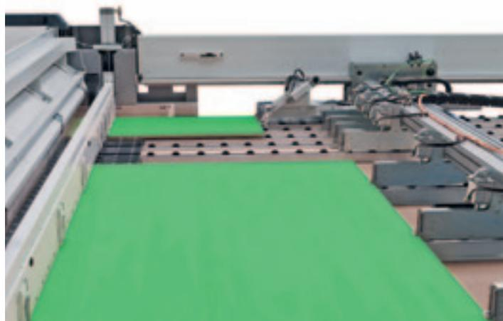
Sezionatura trasversale e longitudinale effettuata in un unico ciclo di lavoro. La presenza di una battuta aggiuntiva consente la sezionatura indipendente di strisce larghe fino a 650 mm.
